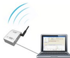
Déchargement des données de température par radio
