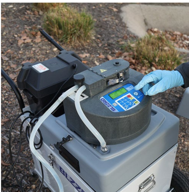
Tête de prélèvement basé sur le contrôleur du 6712, dissociable de l'enceinte réfrigérée
