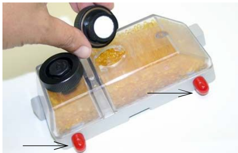
Figure 4-5 Ouverture des chambres de la cartouche de dessiccant
