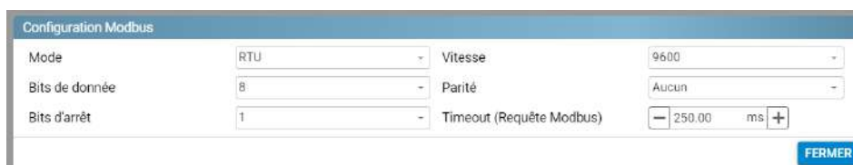
Configuration modbus maître par défaut
