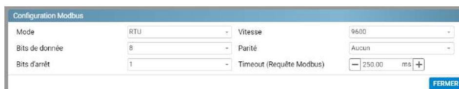
Configuration modbus maître par défaut
