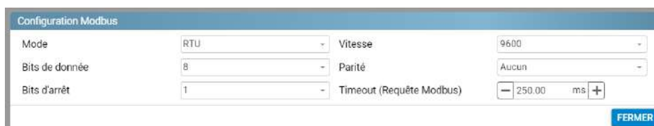
Configuration modbus maître par défaut
