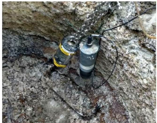
Suspendu à un spit positionné dans le béton, généralement dans la dernière partie du regard sous le tampon. Dans ce cas, les fixations par élingues en inox ou autres chaînes sont couramment utilisées.
