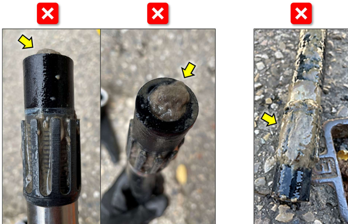
Figure 16 : Illustration d'un encrassement excessif de la cathode (gauche) et de l'anode (droite)
