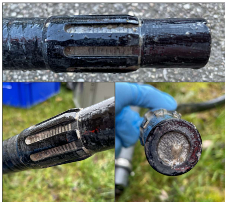
Figure 15 : Illustration d'un encrassement normal et acceptable des électrodes de la cellule de mesure
