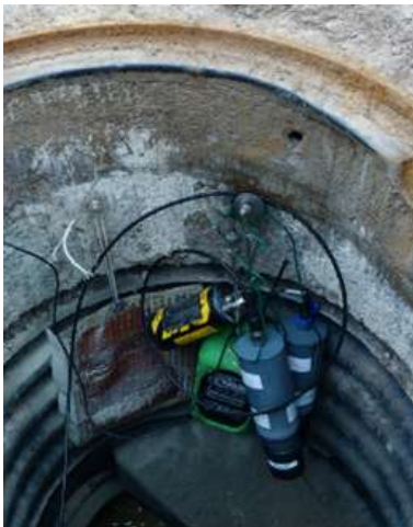
Suspendu à un spit positionné dans le béton, généralement dans la dernière partie du regard sous le tampon. Dans ce cas, les fixations par élingues en inox ou autres chaînes sont couramment utilisées.
