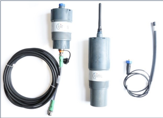
Matériel complémentaire : logger GPRS, sonde US, et antenne gprs déportée
