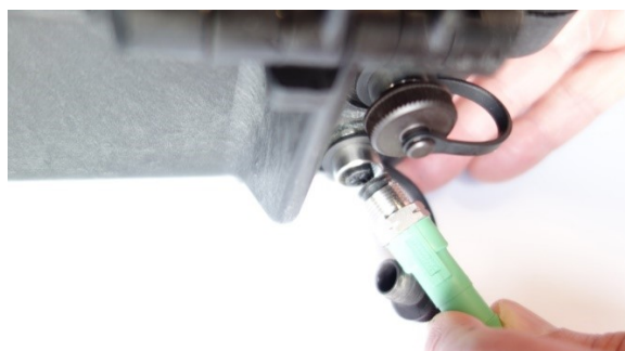
Branchement VLI sur le pack batterie
