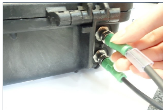
Connexion du logger sur la valise (connecteur du haut)
