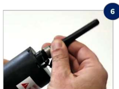
Visser l'antenne au capot
