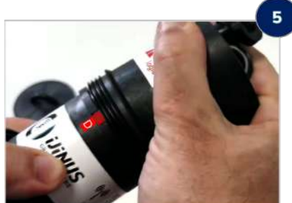
Remettre le capot jusqu'à la buté en faisant attention à bien placer l'encoche d'insertion dans le détrompeur (D)
