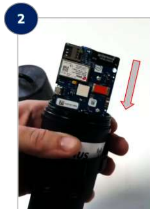
Mettre en place la carte de communication
