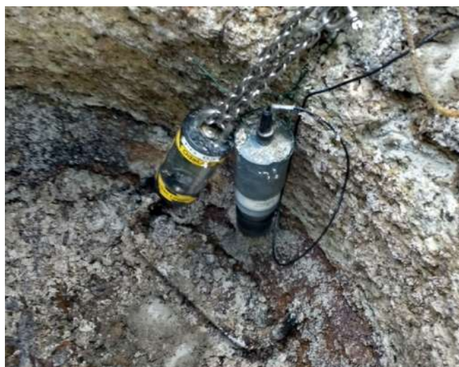
Suspendu à un spit positionné dans le béton, généralement dans la dernière partie du regard sous le tampon. Dans ce cas, les fixations par élingues en inox ou autres chaînes sont couramment utilisées.
