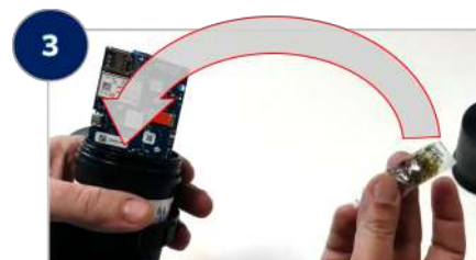
Remplacer le sachet dessiccant en lieu et place de l'existant.
